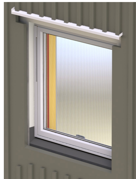
Fig 11. Sekundærtetting rundt hele vinduet. Tettingen hindrer vann for å komme videre inn i veggen.
